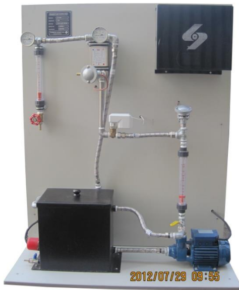
شکل (۱۵) نمایی از سیستم کنترل PID دما
