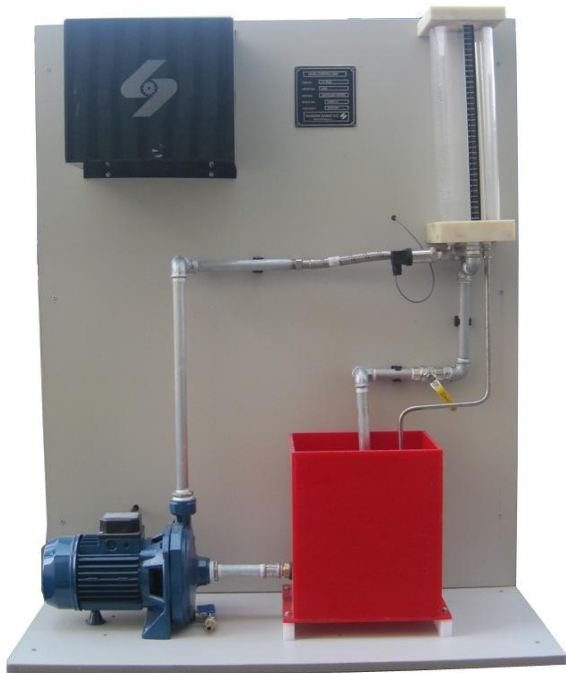
شکل (۱۱) نمایی از سیستم کنترل PID سطح
