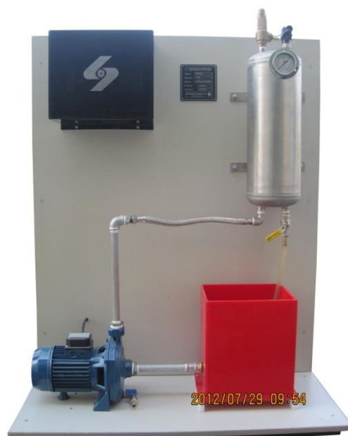
شکل (۱۳) نمایی از سیستم کنترل PID فشار
