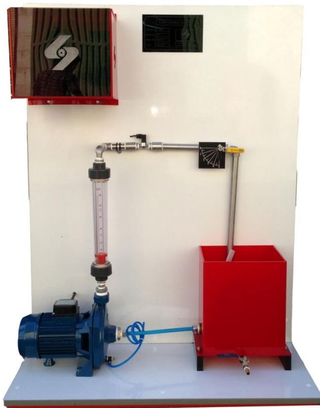
شکل (۱۷) نمایی از سیستم کنترل PID جریان
